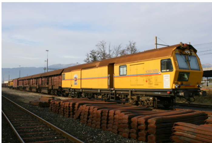
Train meuleur de rails (Scheuchzer S.A.)
