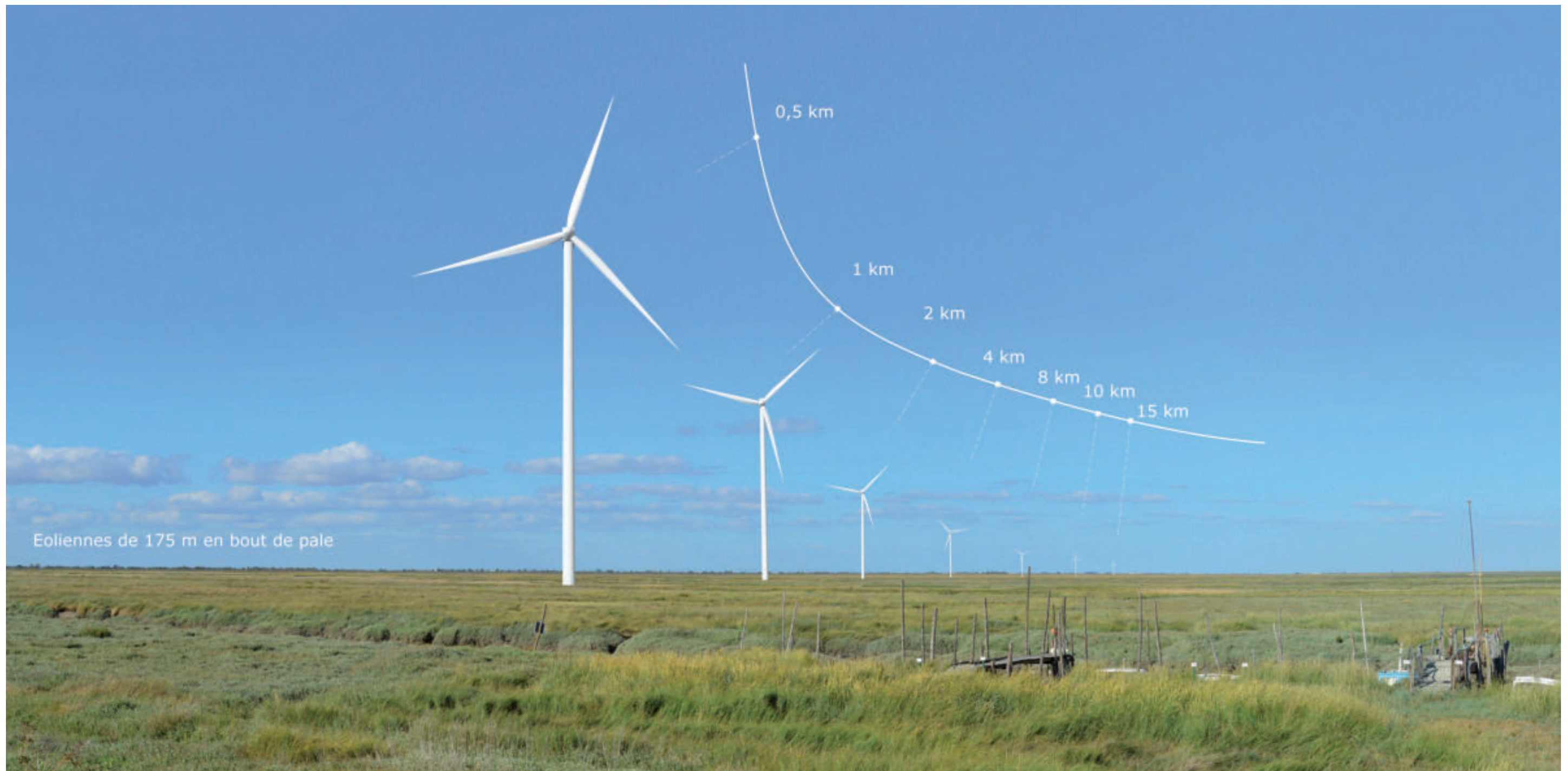
Figure 21 : Simulation en vue réaliste (angle de vue 60°) de la vision des éoliennes selon la distance de l'observateur. Le photomontage doit être observé à une distance de 35 cm pour correspondre à une vue réaliste (impression A3). Source : ENCIS environnement.
