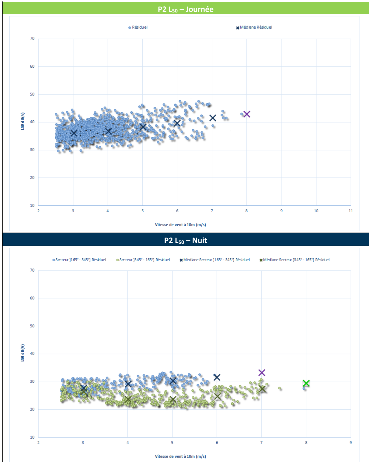
Figure 10 : Bruit en fonction de la vitesse de vent au point P2 - Partie 1
