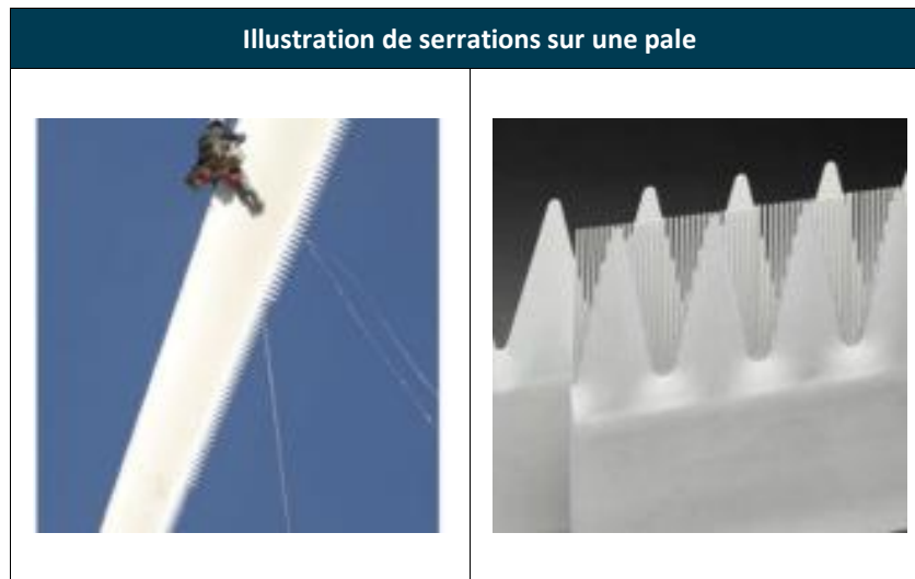
Figure 32 : Illustration de serrations sur une pale
