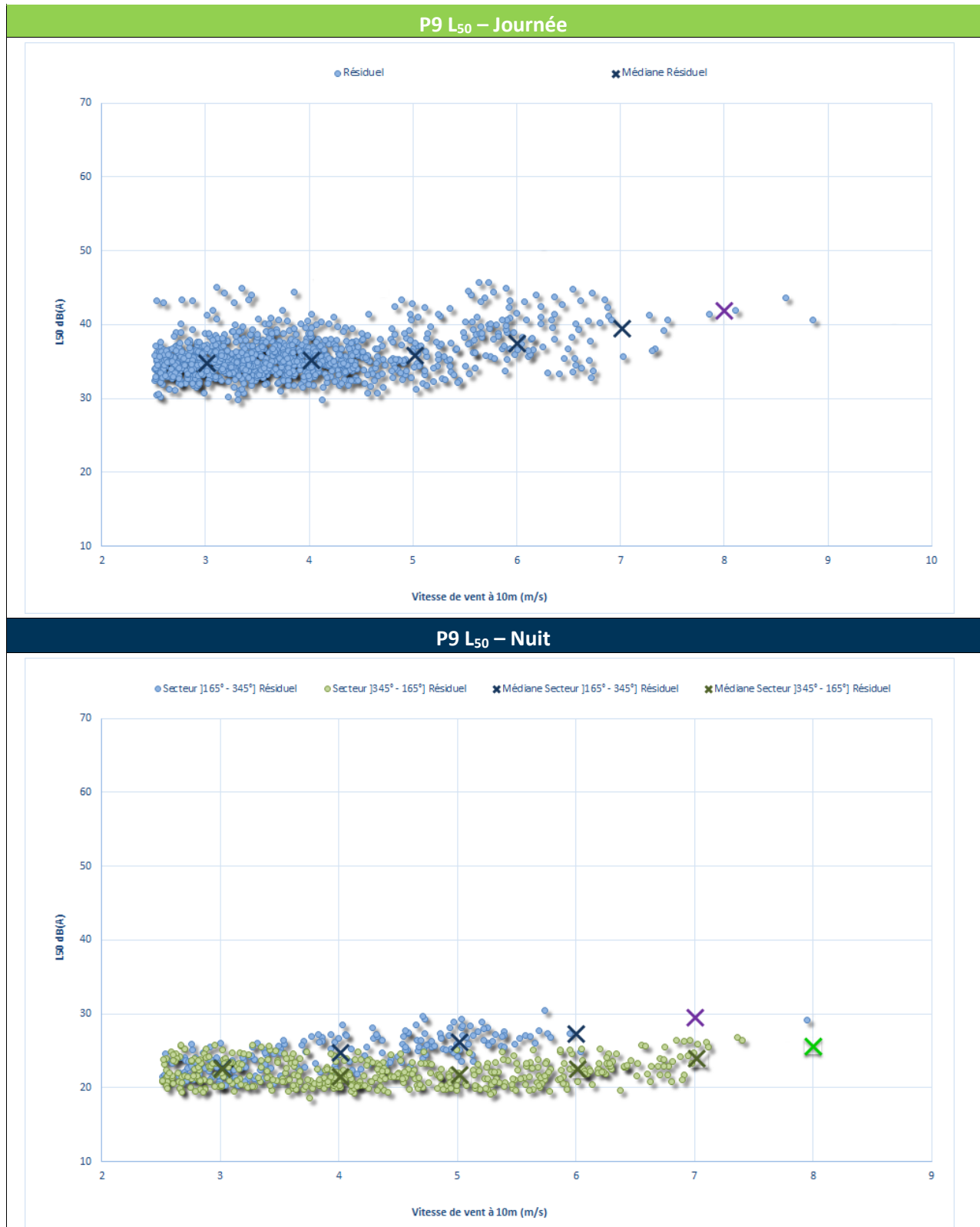
Figure 24 : Bruit en fonction de la vitesse de vent au point P9– Partie 1
