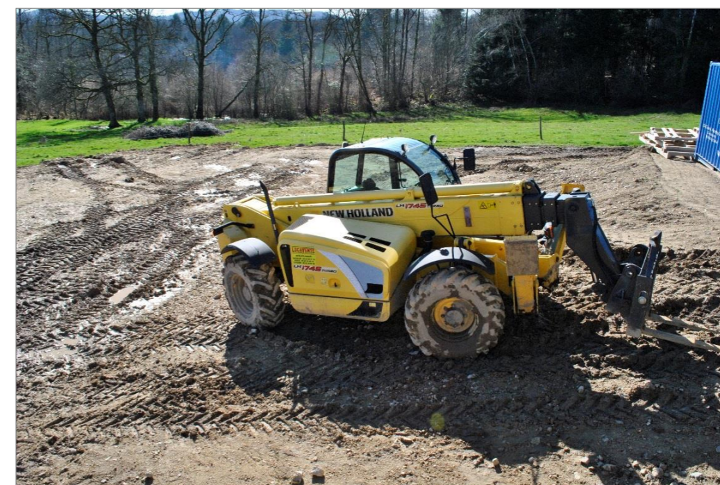
Photographie 30 : Exemple de tassement et d'ornières créés par les engins de chantier
