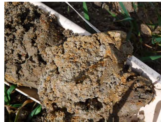
Photographie 18 : Exemple de sol rédoxique avec traces de rouille caractéristiques ainsi que la présence de traces grisâtres
