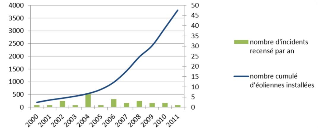
Les recensements effectués montrent que les incidents observés concernent principalement des modèles anciens ne bénéficiant généralement pas des dernières avancées technologiques (par exemple des pales en fibre de verre, plus résistantes, ou un système de freinage aérodynamique – qui équipent les éoliennes V136 du parc de Saint-Barbant).
