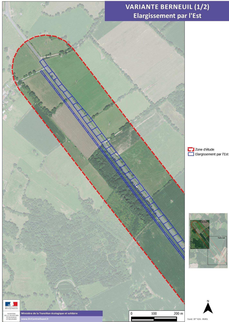
Figure 22 : Variante Berneuil créneau en place élargissement coté Est (1/2)
