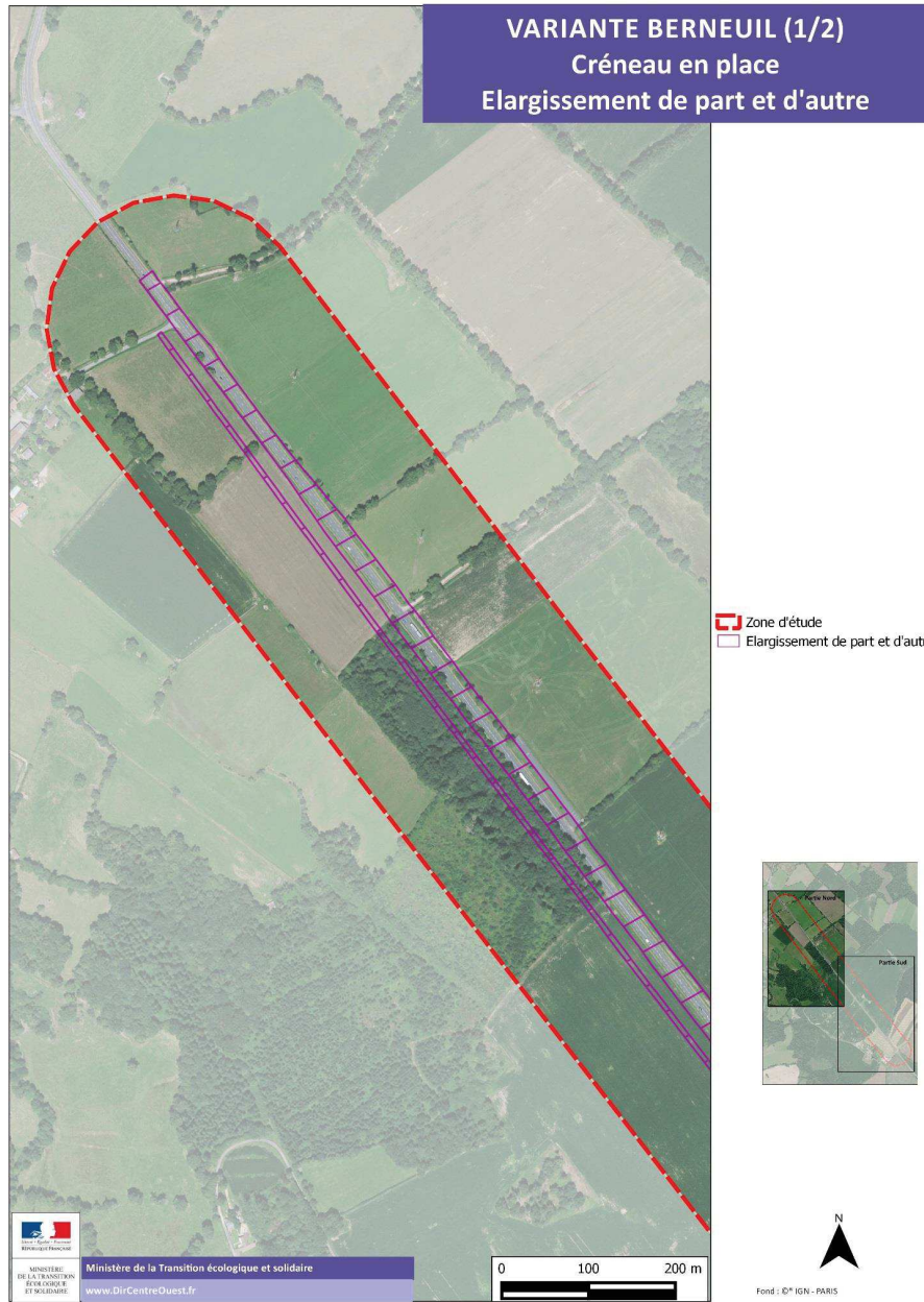
Figure 18 : Variante Berneuil créneau en place élargissement de part et d'autre (1/2)
