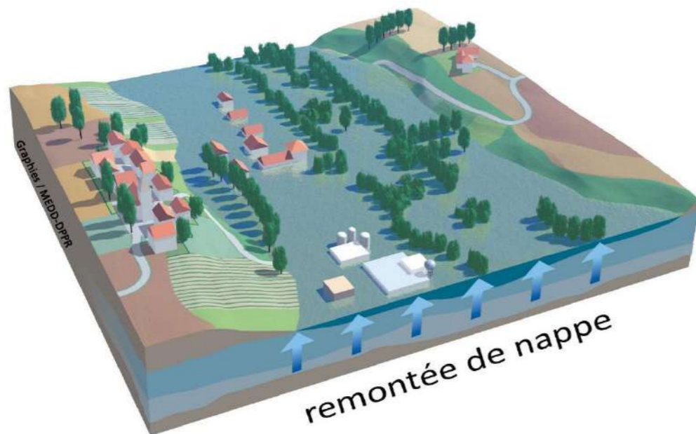
Figure 14 : Le phénomène d'inondation (Source : georisques.gouv.fr)
