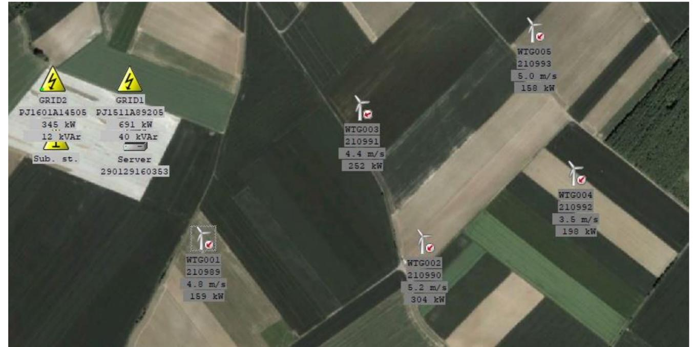
Exemple ci-dessous : Statut d'une éolienne, production, vitesse du vent et de rotation, orientation, etc.
